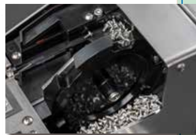
回転ドラムによる汲み上げ方式
